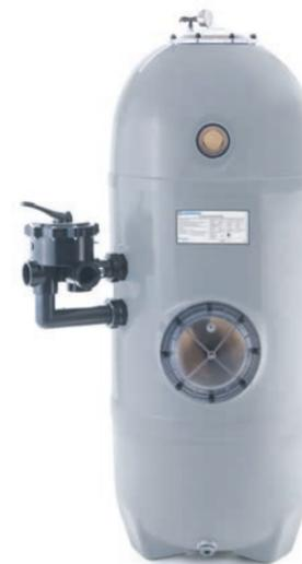
Filtro de alto rendimiento serie San Sebastián, fabricado en poliéster laminado reforzado, de color rojo. Bocas superior y lateral circulares de Ø 220 mm, fabricadas en polipropileno inyectado, sujeción mediante espárragos y tuercas de acero inoxidable. Visor circular roscado de metacrilato transparente.
