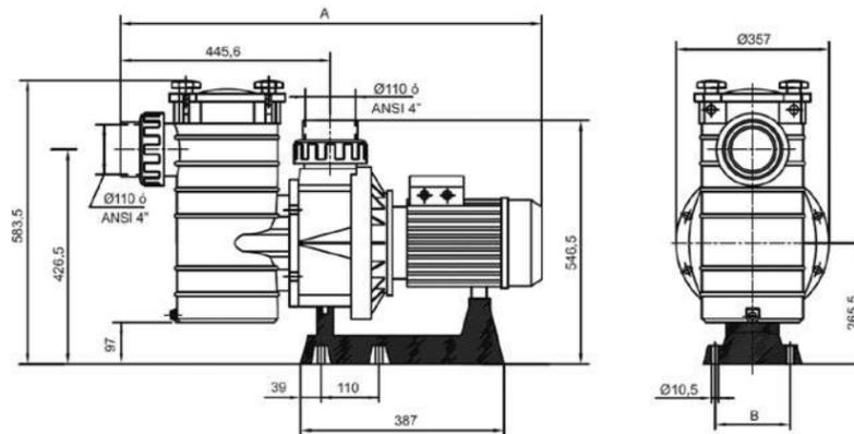
Bomba centrífuga autoaspirante serie NEOPUMP. Posee motor IE3 de 1450 rpm. Cuerpo de bomba inyectado en noryl. Turbina en noryl con FV. Cuerpo, tapa y bulón de palomilla reforzado para soportar presiones de trabajo de hasta 3 kg/cm<sup>3</sup>.
