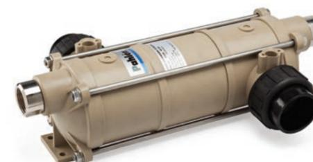
Hi-Temp es un intercambiador de calor en espiral hecho de termoplástico con un alto contenido de vidrio para una mayor durabilidad. Con una bobina de titanio para las instalaciones más exigentes donde existe un alto riesgo de corrosión, como en piscina de agua salada o donde se utiliza un clorador salino.
