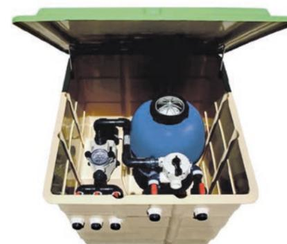
Contenedores completos de filtración fabricados en poliéster con fibra de vidrio y tapa reforzada, que incluyen filtro, bomba, clorador salino, válvula selector, manómetro y cinco válvulas de bola para: skimmer, fondo, limpiafondos, desagüe y retorno respectivamente.
