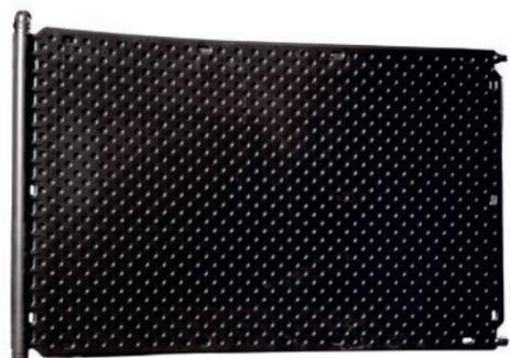
Paneles solares de polietileno, de elevado peso molecular, que ofrecen la posibilidad de alargar la temporada de baño. Disponen de un flujo de 150 - 250 l/m²/h, con una reducida pérdida de presión (0,003 bares a los 200 l/h/m²), con un grado de eficacia de aproximadamente un 85%. Resistente a temperaturas de entre -50 y 115 °C. El agua es bombeada a través de los paneles, por lo que son carentes de corrosión y resistentes al agua de la piscina. Transitables. Disponibles en 1,08 y 1,05 m².
