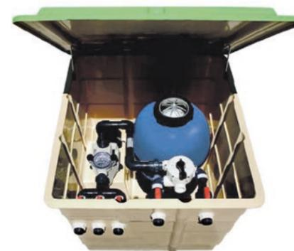
Contenedores completos de filtración fabricados en poliéster con fibra de vidrio y tapa reforzada, que incluyen filtro, bomba, válvula selector, manómetro y cinco válvulas de bola para: skimmer, fondo, limpiafondos, desagüe y retorno respectivamente.
