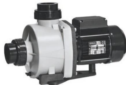
Bombas centrífugas, serie KNG, apta para piscinas privadas. Cuerpo bomba de plástico termoendurecido y turbina en noryl con inserto en acero inoxidable 303. Posibilidad de conectar la bomba mediante enlaces para encolar de Ø 50 ó Ø 63 mm. Cierre mecánico en AISI 316.
