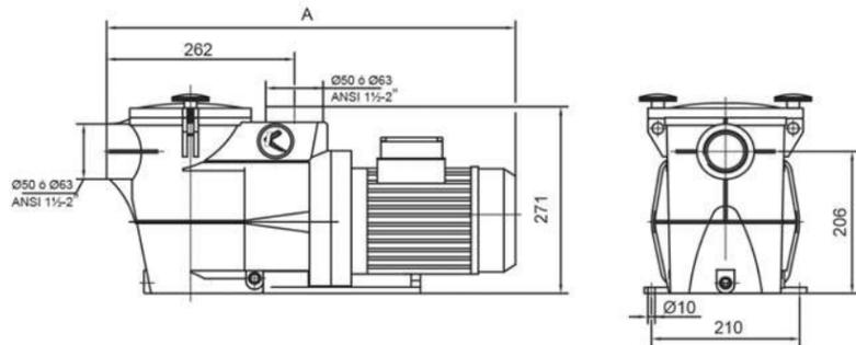
Bomba centrífuga autoaspirante con eficiencia IE3, de instalación sencilla. Incluye enlaces para encolar a Ø 50 (0,33-1,00 cv) o a Ø 63 mm (1,50-3,00 cv). Rodete en noryl, alta resistencia al desgaste, libre de corrosión, con sello mecánico en AISI 316.
