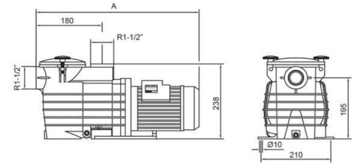
Bombas autoaspirantes de las serie Ondina. Cuerpo en termoplástico inyectado. Turbina en noryl con F.V. y con inserto en AISI 304. Cestillo en material plástico inyectado color blanco. Tapa de cuerpo en policarbonato transparente.
