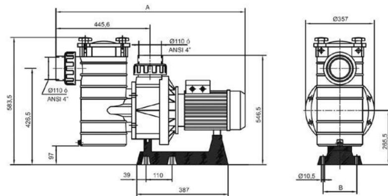
Bomba centrífuga autoaspirante, serie HCP4000. Cuerpo de bomba inyectado en noryl. Turbina en noryl con FV. Prefiltro de gran capacidad. El cierre de la tapa se realiza por medio de cuatro palomillas abatibles con espárragos en acero inoxidable.
