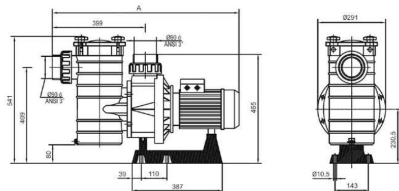
Bomba centrífuga autoaspirante, serie HCP3800. Cuerpo en termoplástico inyectado. Turbina en noryl con FV. Cestillo en material plástico inyectado color blanco. Prefiltro de gran capacidad (8 litros).
