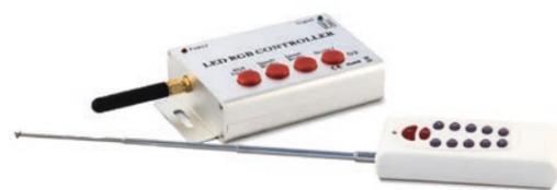
Sistema que permite, con un único mando, la sincronización perfecta de los proyectores y lámparas, con la orden realizada. Permite sincronizar hasta 8 proyectores o lámparas, diferentes.
