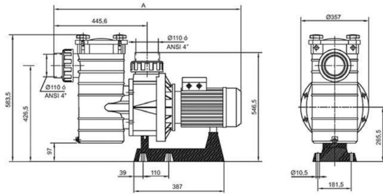
Bomba centrífuga autoaspirante serie HCP4200. Posee motor IE3 de 1450 rpm. Cuerpo de bomba inyectado en noryl. Turbina en noryl con FV. Cuerpo, tapa y bulón de palomilla reforzado para soportar presiones de trabajo de hasta 3 kg/cm<sup>3</sup>.
