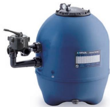
Filtros domésticos de poliéster laminado, serie BR, color gris. Incluye manómetro y válvula selector de 6 vías con enlaces (de 1 1/2" para Ø 400 mm y Ø 640 mm y de 2" para Ø 680 mm, Ø 760 mm y Ø 900 m).
