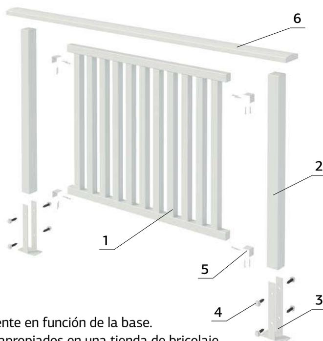
La fijación al suelo tiene que hacerse correctamente en función de la base. Recomendamos adquirir los artículos de fijación apropiados en una tienda de bricolaje.
