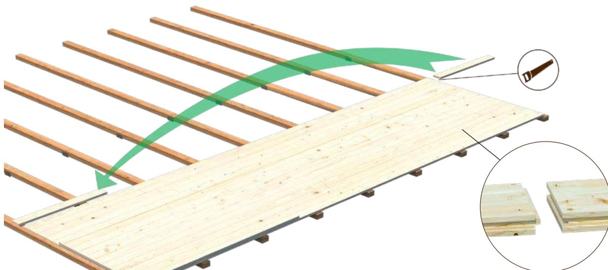
Tablas de suelo con doble encaje en la punta
