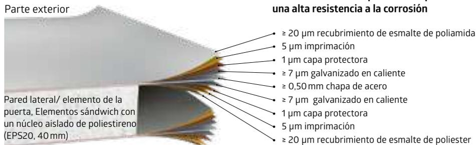
Pared lateral/ elemento de la puerta, Elementos sándwich con un núcleo aislado de poliestireno (EPS20, 40mm)
